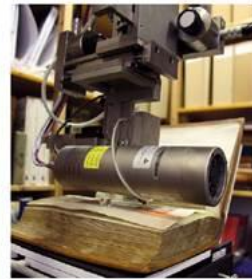
Abb. 16 - Anordnung der Geräte für XRF-Analyse des Breslauer Psalters. Ill. 16 - Setup used for XRF analysis of the Breslau Psalter.
